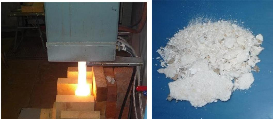
Рис. 1. Плазменный стенд «Высокочастотный факельный плазмотрон на базе генератора ВЧГ8-60/13» для исследования процесса плазменной иммобилизации ИЛО
