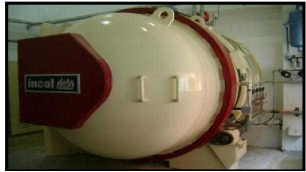
Figura 13. Elaboración de laminados de fibra de carbono y autoclave para el proceso de polimerización.
