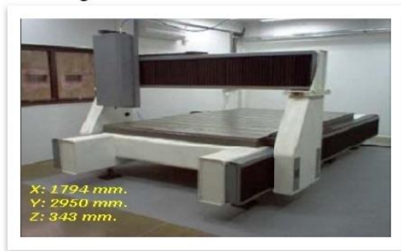
Figura 14. Izquierda: Fresadora para el mecanizado de paneles. Derecha: Equipo CNC para la fabricación de piezas metálicas.
