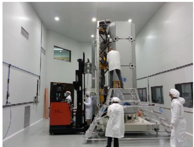
Figura 18. Integración en CNEA del Modelo Estructural de la Antena SAR.
