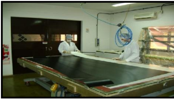
Figura 13. Elaboración de laminados de fibra de carbono y autoclave para el proceso de polimerización.
