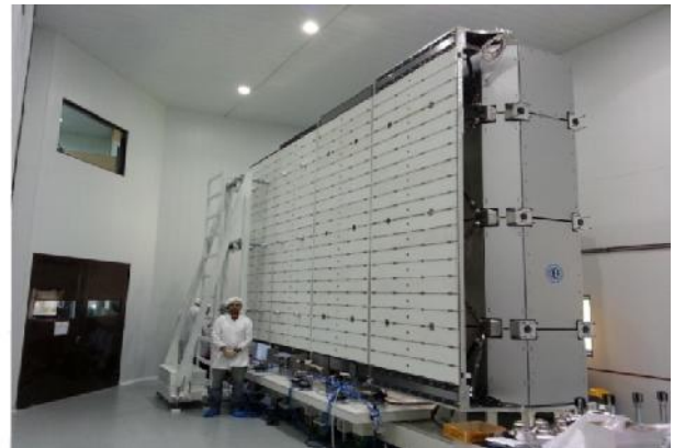
Figura 19. Modelo Estructural de la Antena SAR en CNEA.
