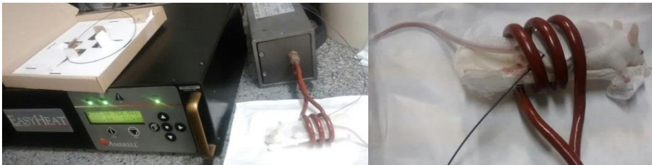
Figura 2.1 – Tratamento de hipertermia magnética do teste preliminar in vivo .
