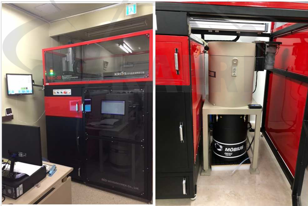
그림 11. 감마선 방출핵종 자동 시료 교환장치 및 감마분광분석기
