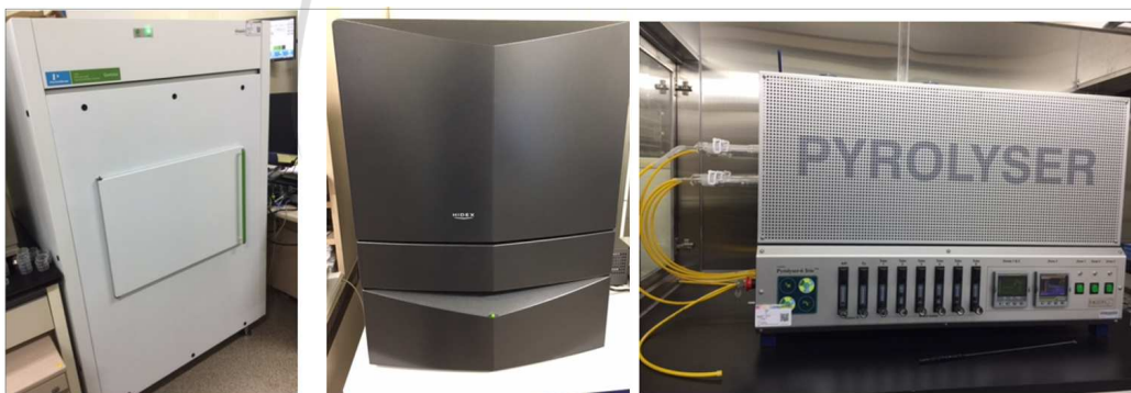
그림 14. 액체섬광계수기(LSC) 4 대 보유 및 ^{14}\text{C}/^3\text{H} 추출을 위한 연소기
