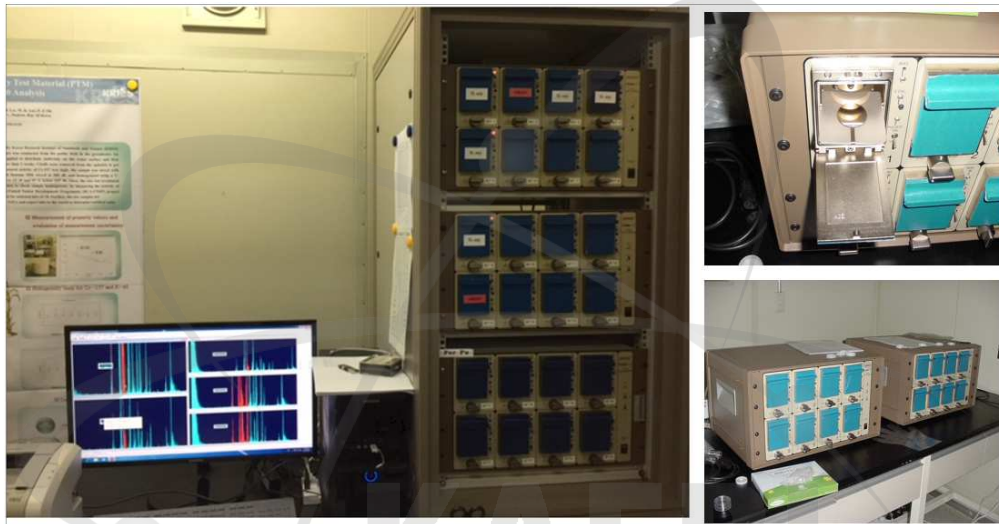
그림 13. 알파분광분석기(alpha spectrometry) 40 개 시료 동시 측정 가능
