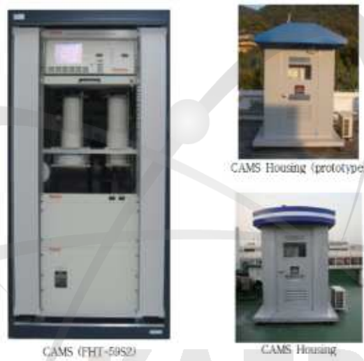
그림 16. 연속 공기부유진중 전알파. 전베타 측정장비
