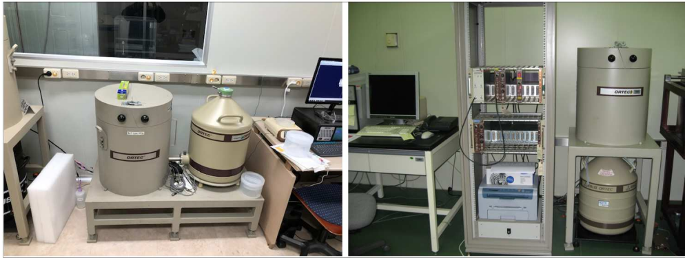
그림 12. 감마분광분석기(gamma spectrometry) 10 대 보유
