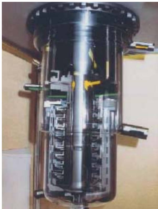
Fig. 58. Éclaté d'un extracteur centrifuge Robatel utilisé à l'usine de La Hague.
