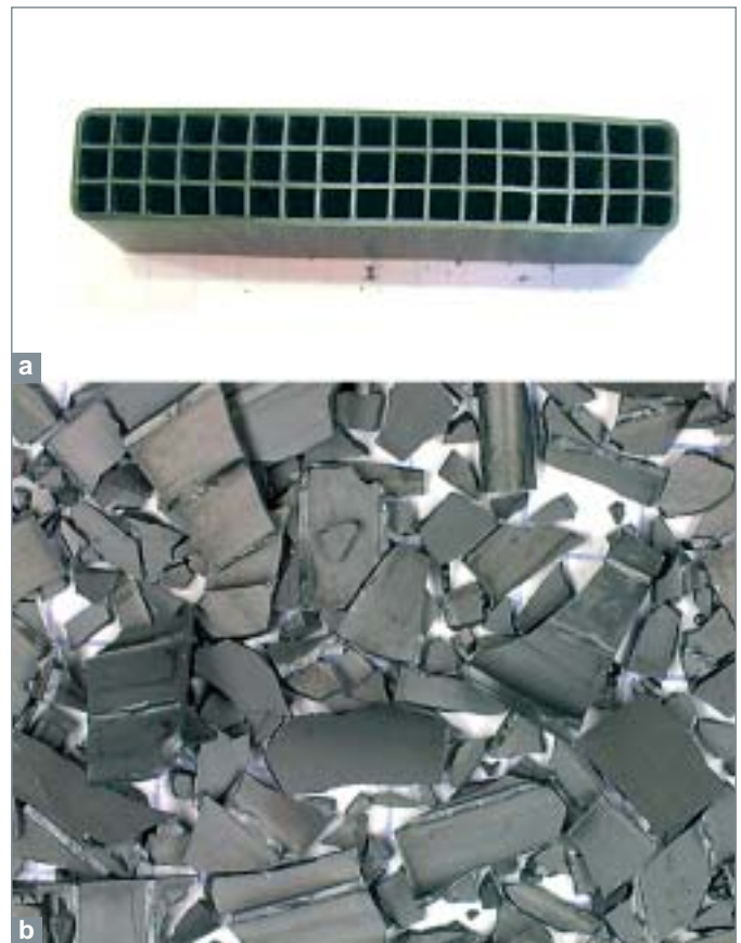
Fig. 95. Vue d'une plaque macro-structurée à alvéoles en SiC avant traitement par courants pulsés (a) et après 1 impulsion (b).
