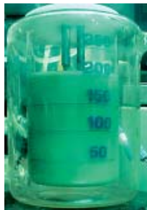
Fig. 150. Synthèse, à l'échelle du gramme, d'un oxalate mixte U-Pu-Np-Am 78/20/1/1 dans ATALANTE.
