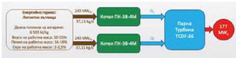
Фиг. 1. Принципна схема на блок 177 MW
