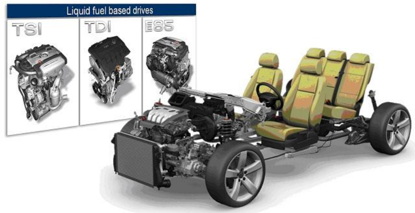
Bild 2: Modularer Querbaukasten MQB von VOLKSWAGEN [16]
