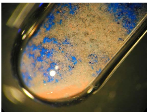
Abbildung 28. Umsetzung von \text{CuF}_2 mit elementarem Kupfer in Ammoniak im Bombenrohr bei Zimmertemperatur. Neben farblosen Kristallen können tief-blaue Kristalle und elementares Kupfer beobachtet werden.
