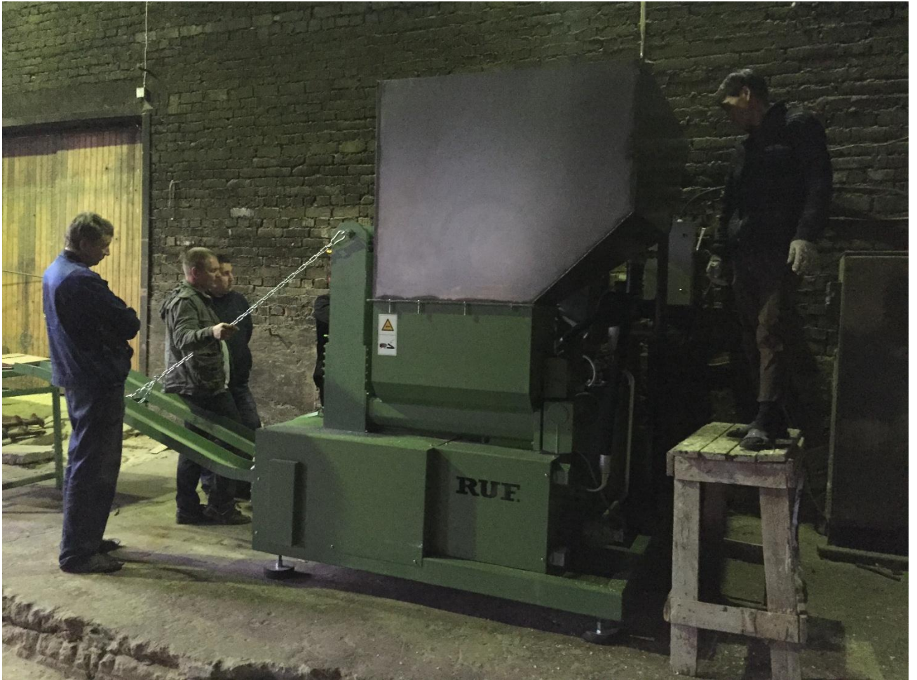
Рисунок 3.2 – Проведение экспериментов по брикетированию с использованием прессы RUF600
