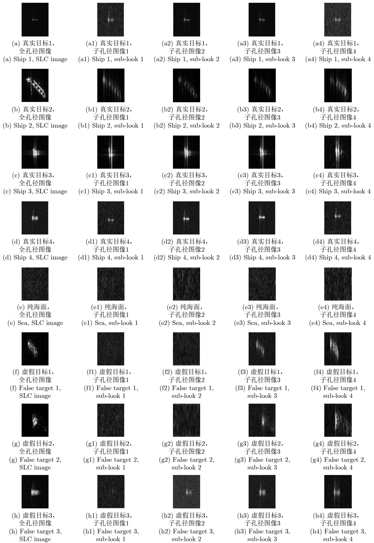
图4 真实船舶目标、纯海面、多通道虚假目标切片的全孔径图像及其对应子孔径图像
