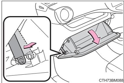
3 グローブボックス側面を片側ずつ内側に押し、上部のツメをはずす
