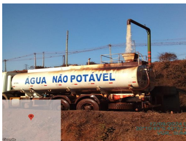
Figura 27 - Abastecimento de caminhão pipa com água para umecção das vias de acesso (Fonte: Vale, setembro de 2024)
