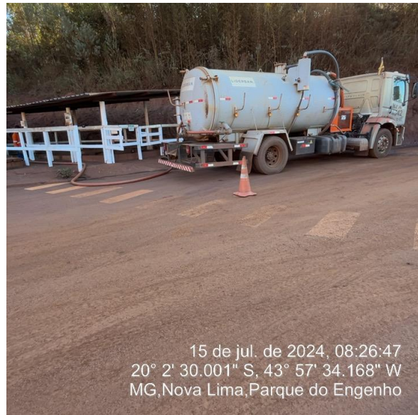
Foto 21. Higienização do tanque estanque. (Fonte: Vale, julho de 2024).
