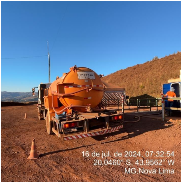
Foto 20. Higienização de banheiros hidráulicos. (Fonte: Vale, julho de 2024).
