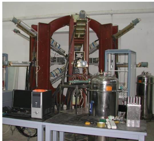
Fig. 6. The HPGe detector array at CIAE.
