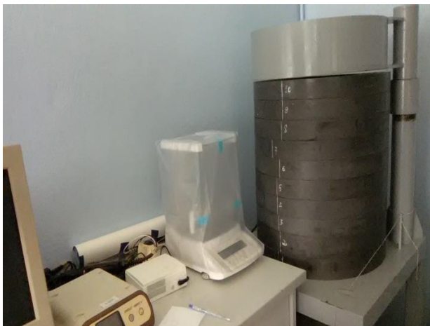
Fig. 6. High efficient HPGe spectrometer.
