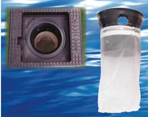
Figur 4. Brunnsfilter från SEKA Miljöteknik med två utanpåliggande filterpåsar (200 och 50 \mu\text{m} maskstorlek) använda i projektet för att kvantifiera mikroplast i dagvatten.
