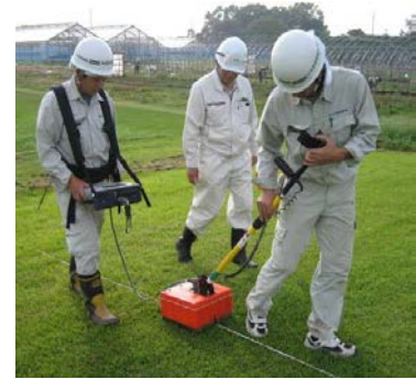
写真6 レーダー探査実施状況 (写真撮影：環境省)
