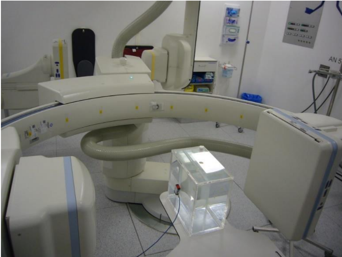
Abb. 4.1 Messaufbau bei 90° Angulation des C-Bogens
