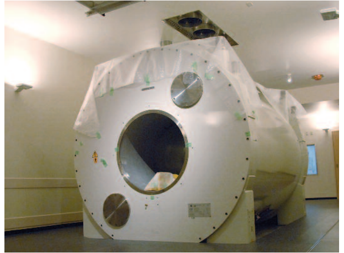
土台部分が床上に固定された 7T-MRI 研究機器
