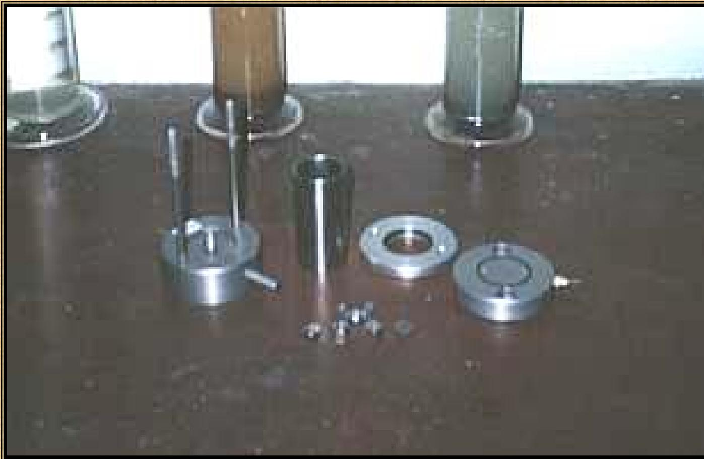
**Piezas del molde donde es colocado el espécimen para realizar el Ensayo de Pinhole**
