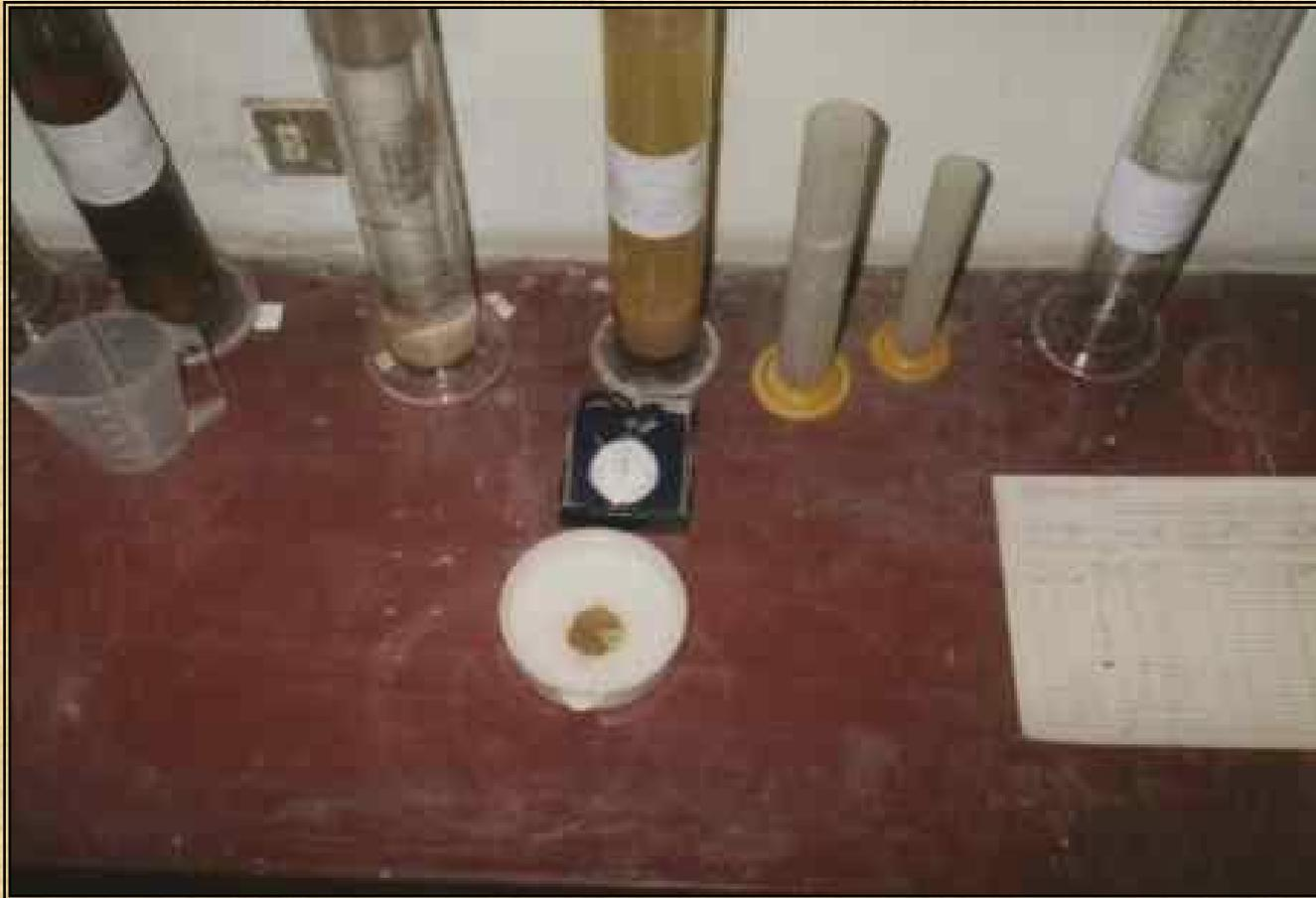
**Obsérvese los flóculos formados en la superficie del agua. Esto es típico en un suelo dispersivo. El resultado del ensayo es un indicio de las características dispersivas del suelo**
