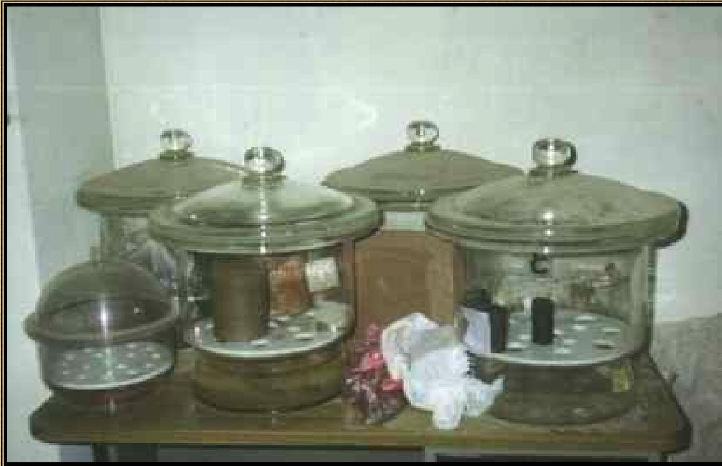
**Ensayo de Pinhole, obsérvese el espécimen compactado. Luego de transcurridas 24 y 48 horas se procederá a iniciar el ensayo**
