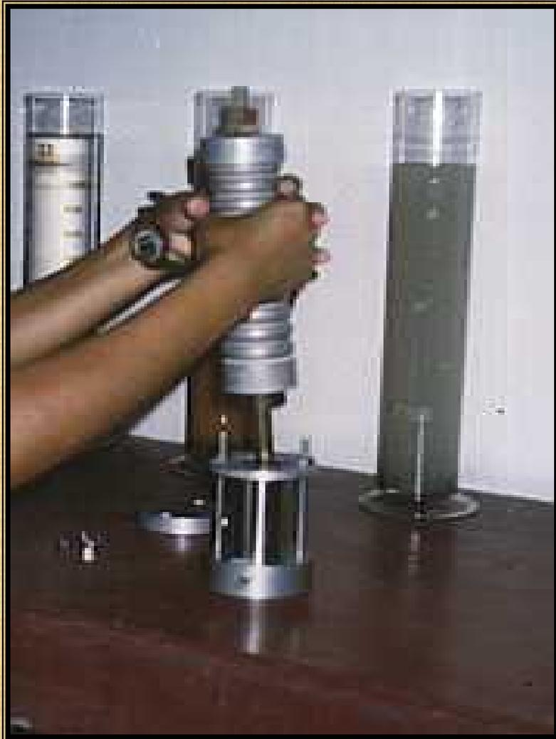
**Ensayo de Pinhole, compactando el espécimen en el cilindro del equipo de Pinhole a través de 05 capas y 16 golpes por capa**
