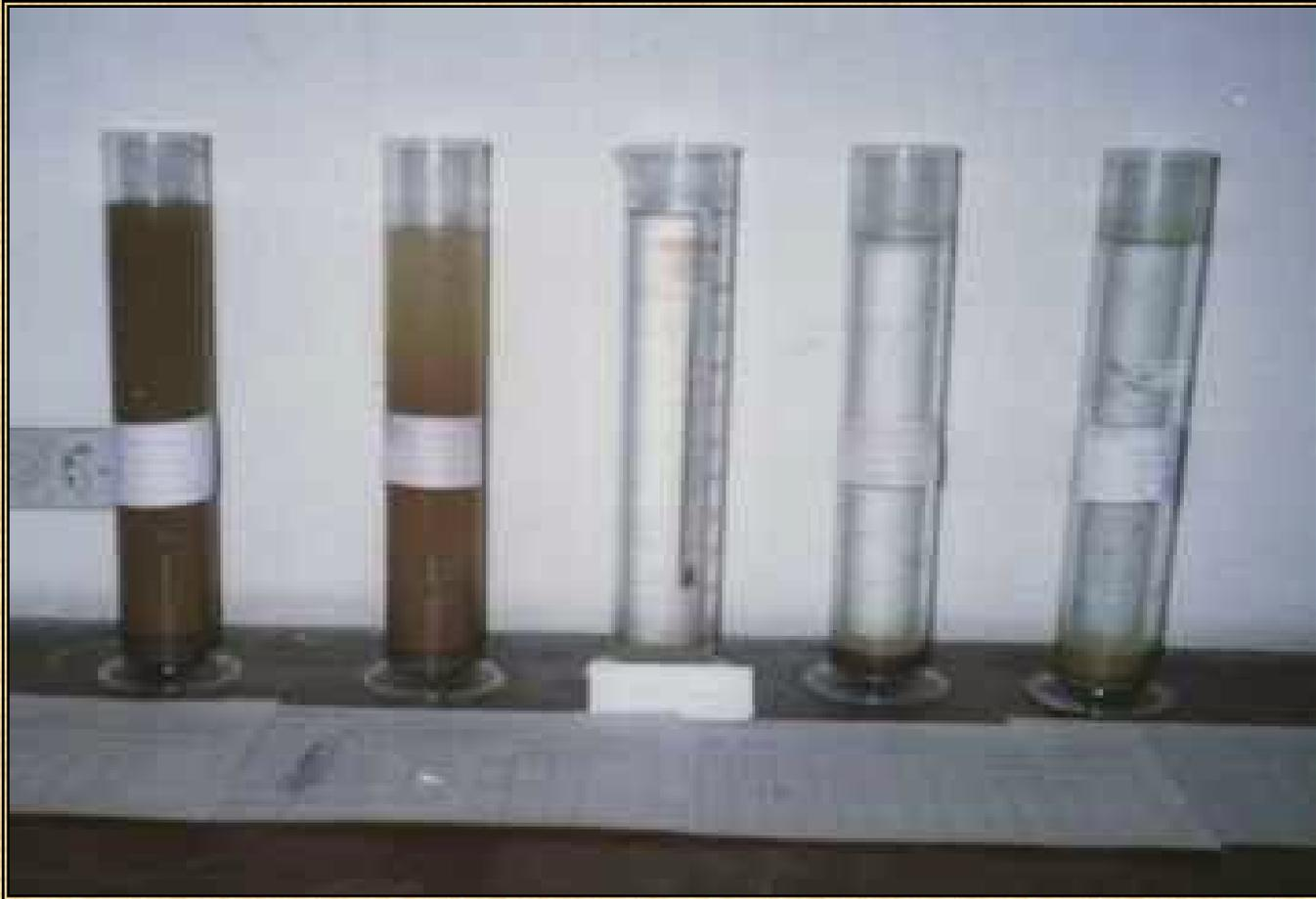
**Ensayo del Doble Hidrómetro; los recipientes del lado derecho son los ensayados sin el defloculante y sin agitación mecánica**
