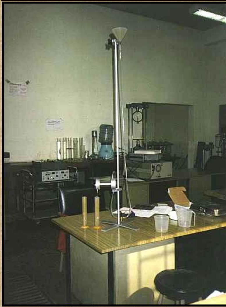
**Ensayo de Pinhole,
