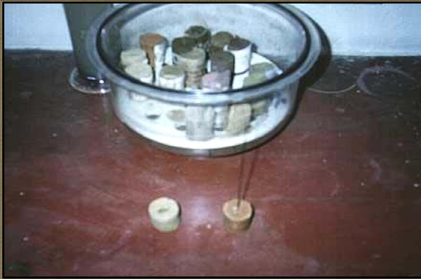
**Ensayo de Pinhole, obsérvese la diferencia en los resultados de un espécimen de suelo dispersivo (lado izq.) y otro no dispersivo (lado der.)**
