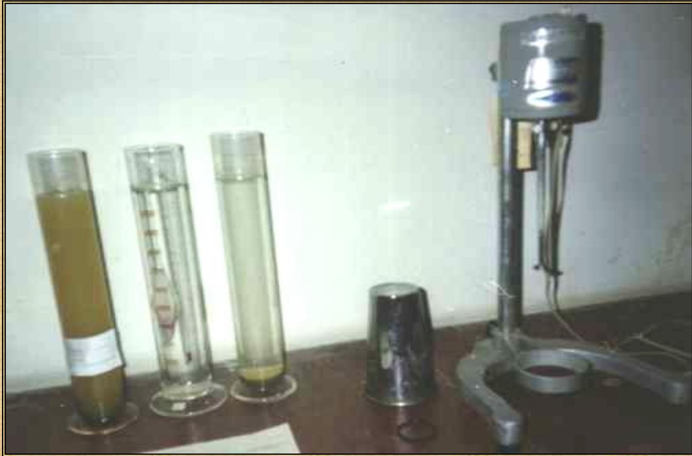
**Equipo utilizado en el Ensayo del Doble Hidrómetro**
