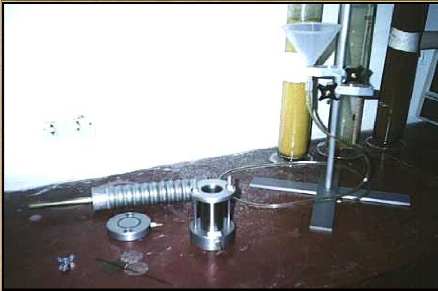
**Ensayo de Pinhole, piezas del equipo a utilizar en el ensayo listo para compactar**
