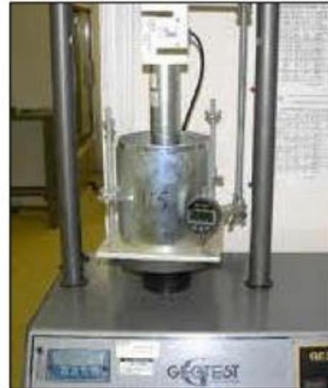
Ensayo (ASTM D1883)
