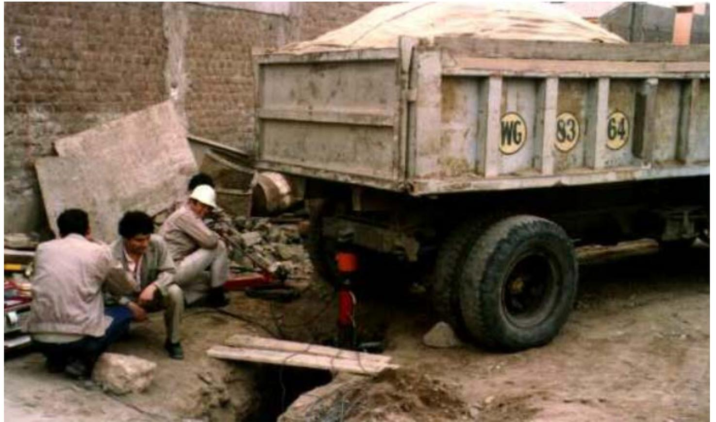
**EVALUACIÓN DEL COLAPSO IN-SITU CON PRUEBA DE CARGA SATURADA
