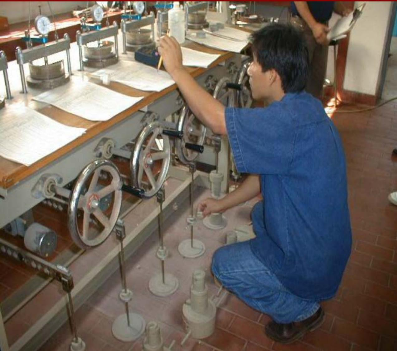
**ETAPA DE CARGA PARA EL ENSAYO DE CONSOLIDACIÓN**
