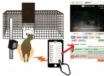
獣が檻に侵入するとセンサーが反応し、スマートフォン・パソコンへ通知が届く
