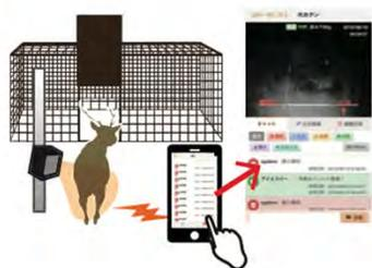
獣が檻に侵入するとセンサーが反応し、スマートフォン・パソコンへ通知が届く
