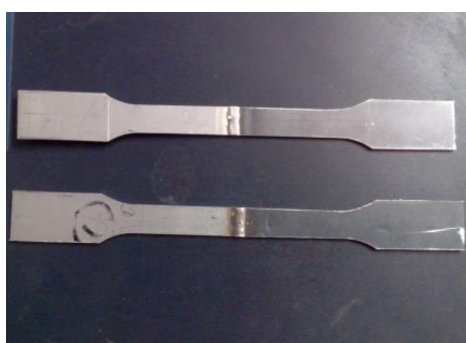
Fig-4, Tensile Test Specimens
