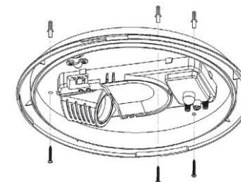
Vissez une ampoule (E27) dans le filetage. Remettez l'abat-jour en place sur la base de la lampe.
