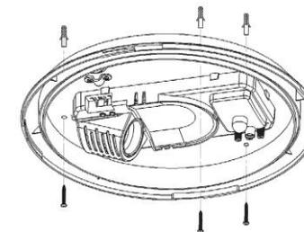
Schrauben Sie eine Lampe (E27) in das Gewinde. Setzen Sie den Lampenschirm wieder auf die Lampenbasis.
