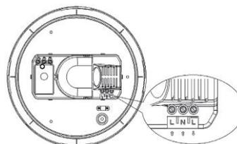
Vissez la base de la lampe au plafond, à l'aide des trous situés dans la base (il se peut qu'ils doivent être transpercés).
