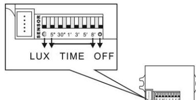
Stellen Sie den LUX-Schalter links nach oben (Mond), reagiert die Lampe nur in einer dunklen Umgebung. Wenn Sie den LUX-Schalter nach unten schalten (Sonne) reagiert die Lampe auch am Tag. Wenn Sie den Lichtschalter rechts nach oben stellen (ON) ist die Lampe dauerhaft an. Wenn Sie den Lichtschalter nach unten stellen (OFF) reagiert die Lampe nur auf Bewegung.
