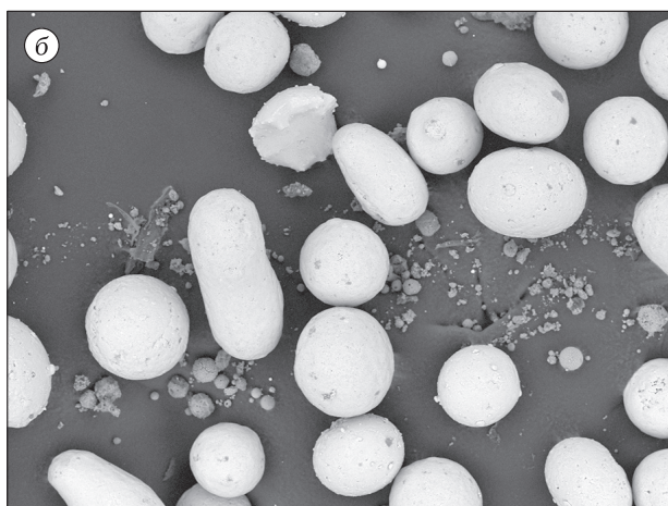
Рис. 8. Пример эффективного обеспыливания порошков олова на ЭМК: а – пылевая, б – крупная фракция.
