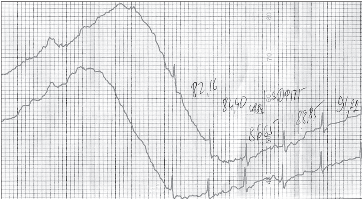
Рис. 1. Спектр поглощения образца NaF после четырех актов нагружения: сверху – параллельная, внизу – перпендикулярная ориентация оси диска в магнитном поле. Секстет узких линий – спектр ЭПР Mn^{2+} в эталоне MgO.
