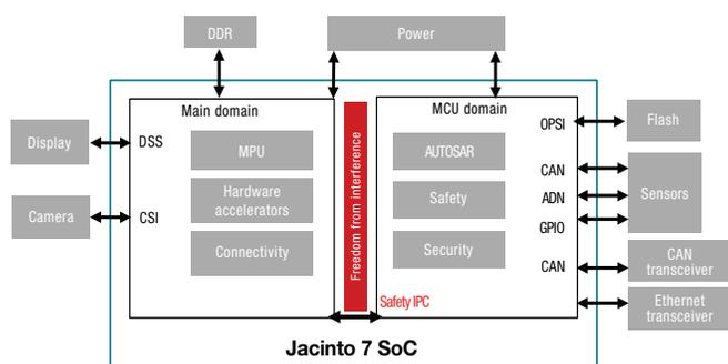
图 2. 基于 Jacinto 7 SoC 的系统架构。
